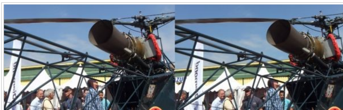
Poutre en treillis, Arbre de transmission, Turbine, Rotor - Alouette II Version marine, Mandelieu-La-Napoule
