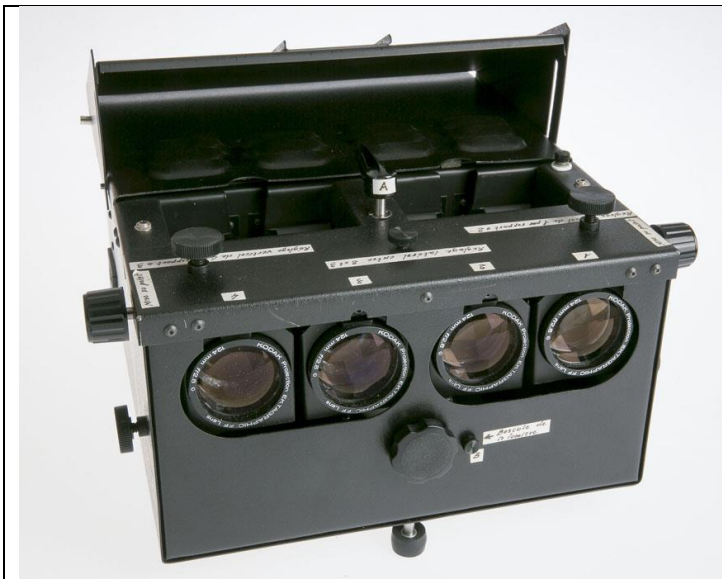
Projecteur stéréo Kodak à 4 objectifs adapté pour le fondu-enchaîné.
