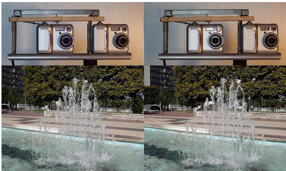
Couplage avec synchronisation mécanique de deux Nikon Coolpix 775 par C. Barbotte, la photo du jet d'eau prouve la qualité de la synchronisation obtenue, bulletin n°893, janvier-février 2006
